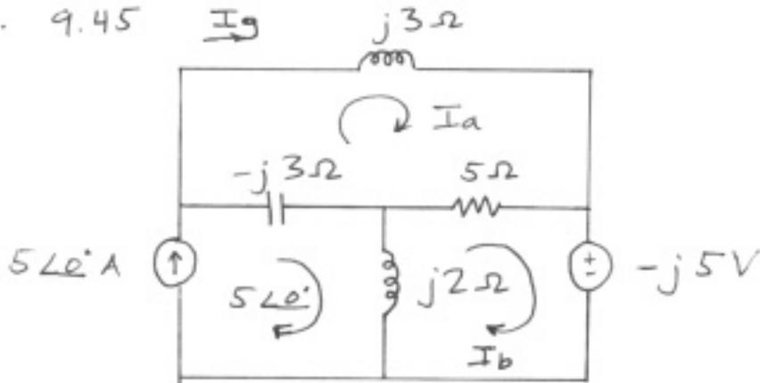
$$\text{Loop A: } j3I_a + 5(I_a - I_b) - j3(I_a - 5) = 0$$
