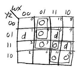
$$(\omega + \overline{X} + \gamma) \cdot (\overline{X} + \overline{2}) (\overline{\omega} + \overline{\gamma})$$
