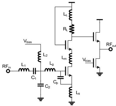
Fig.5. LNA schematic
