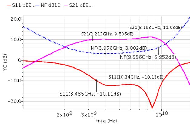
Fig. 11. LNA simulation result: NF, S11, S21
