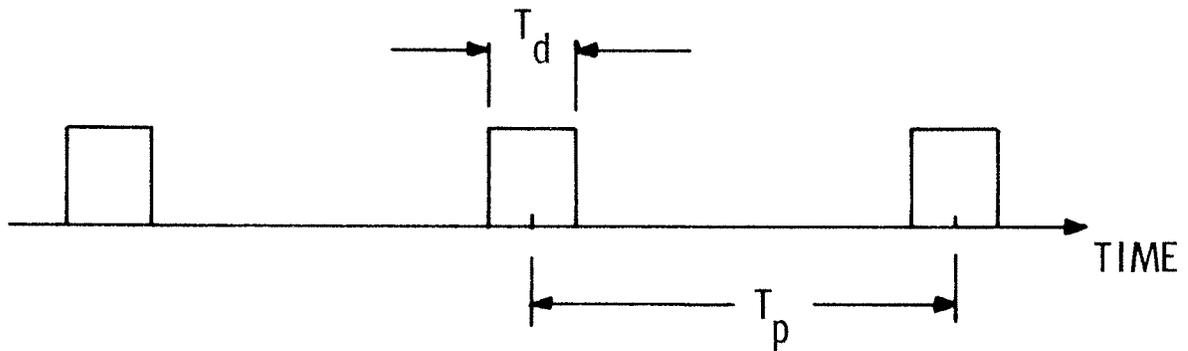
Fig. 2. 12. Periodic Pulse Signal
