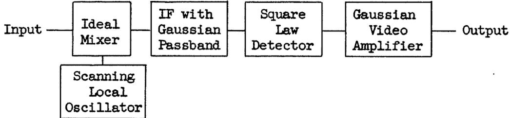
Fig. B.1 BLOCK DIAGRAM OF PANORAMIC RECEIVER
