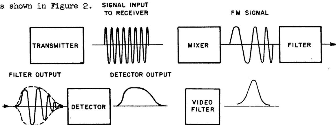
FIG 2. BLOCK DIAGRAM OF IDEALIZED PANORAMIC RECEIVER
